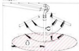
Рис. 37. Пример расчёта зоны, опасной для нахождения людей при перемещении раздаточной мачты бетононасоса
